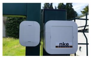
Le CAPTEUR CLOS'O intègre un sensor magnétique à haute sensibilité. Placé sur le dormant, le CAPTEUR CLOS'O détecte l'ouverture ou la fermeture du battant. Un boitier aimant est fixé sur la partie mobile en face du Capteur. Le CAPTEUR CLOS'O transmet le changement d'état du battant après que la position soit confirmée.
