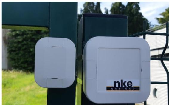
Le CAPTEUR CLOS'O intègre un sensor magnétique à haute sensibilité. Placé sur le dormant, le CAPTEUR CLOS'O détecte l'ouverture ou la fermeture du battant. Un boîtier aimant est fixé sur la partie mobile en face du Capteur. Le CAPTEUR CLOS'O transmet le changement d'état du battant après que la position soit confirmée.
