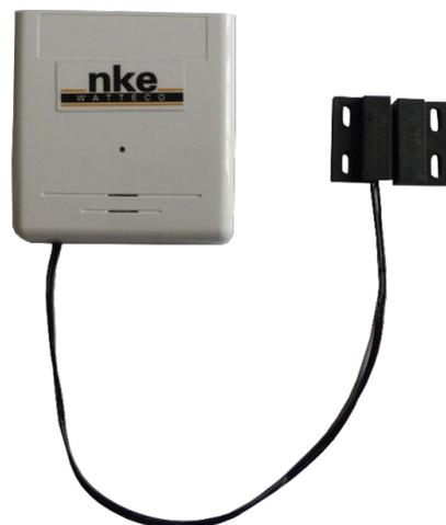
Le capteur Magnet'O se compose d'un Capteur Pulse S0 et d'un sensor ILS associé à aimant. Le Capteur est fixé sur le châssis et l'aimant est fixé sur l'ouvrant (par vis et oblongs). L'installation et la mise en service sont rapides et simples.
