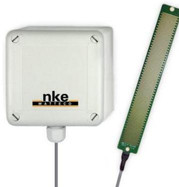
Le principe de fonctionnement est la mesure de variation de tension aux bornes du pont diviseur de tension formé par la sonde de résistance variable ( $R = 300 \text{ k}\Omega$  à sec,  $R = 2 \text{ k}\Omega$  en humide) et l'entrée analogique 0-10V du capteur PRESS'O.
