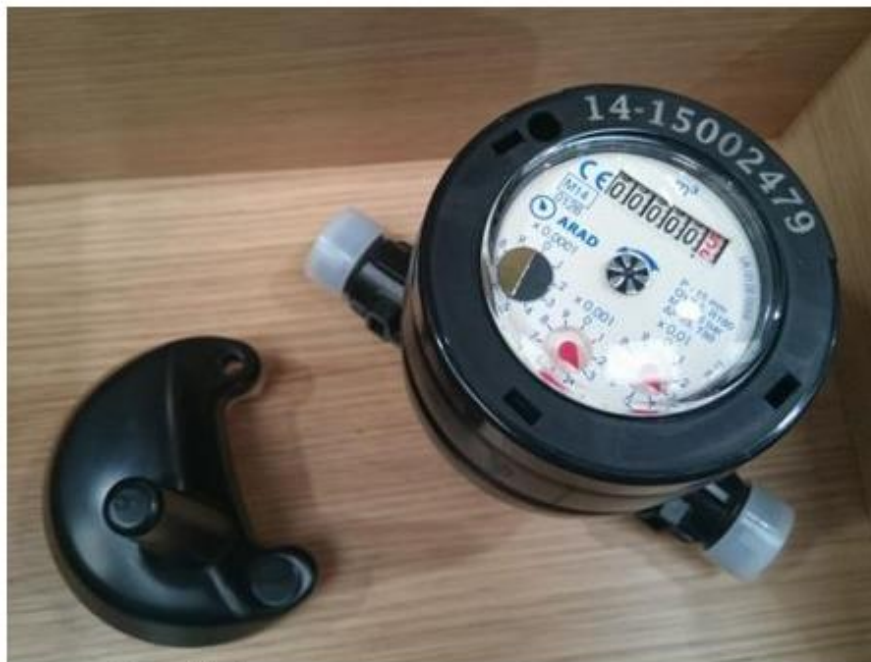
Sens'O, la tête de télérelève de compteur d'eau de NKE Watteco
