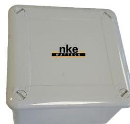
Le capteur SKYDOME SIGFOX™ est un système embarqué fonctionnant sur pile qui permet la surveillance de l'état d'ouverture ou de fermeture d'une fenêtre de toit en mesurant périodiquement l'inclinaison du boîtier monté solidairement de la fenêtre de toit. La mesure de l'angle a pour référence l'axe vertical.
